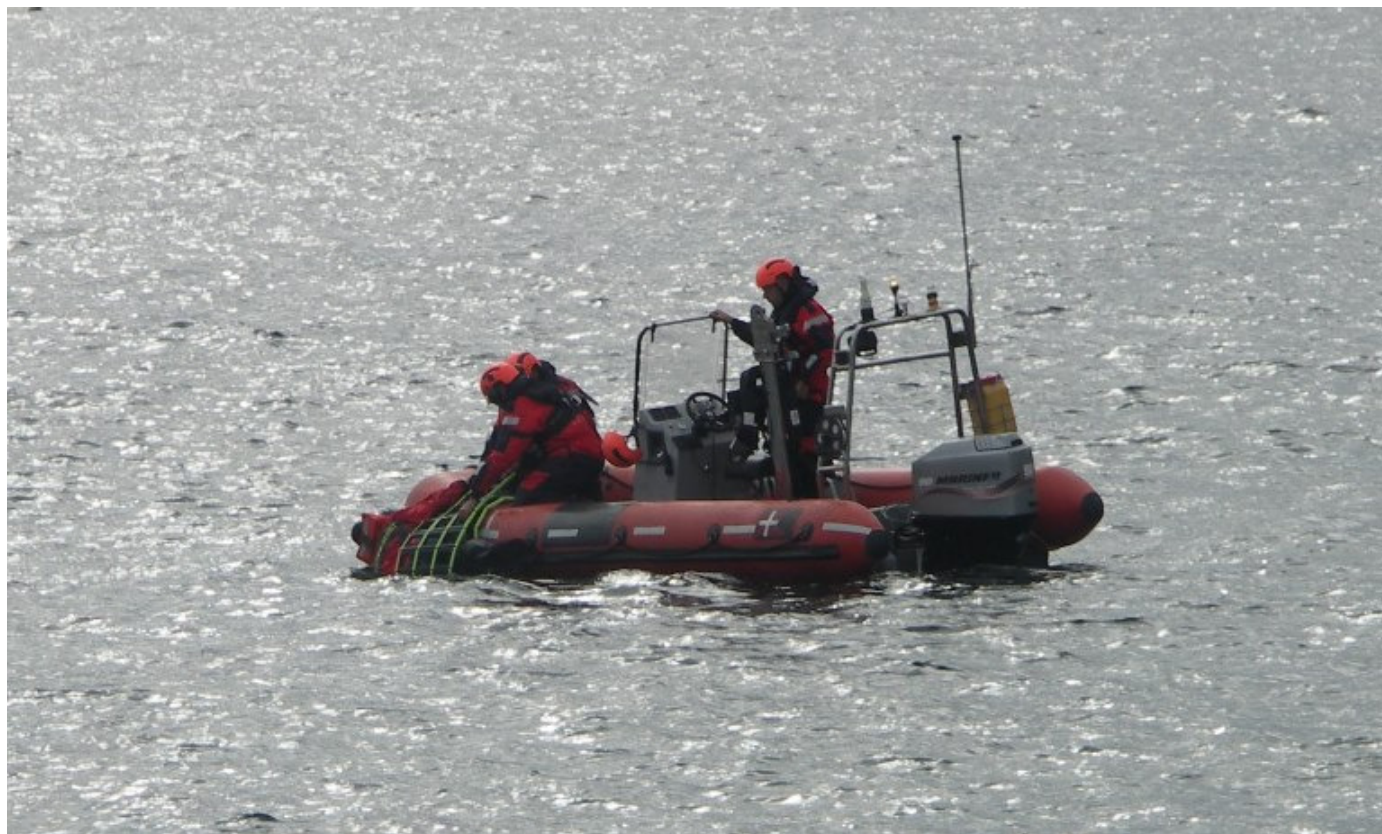
Opsamling af mand i vandet fra gummi båd med redskabet "Jasons Cradle", et net af hård plast, der gør det væsentligt lettere, at trække folk op fra vandet.
