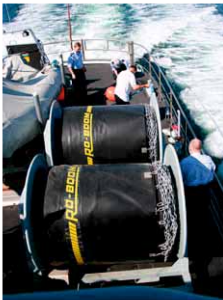
900-klassemens lange agterdæk og de to moduler med flydespærringer. Foto: Jess Abrahamsen
