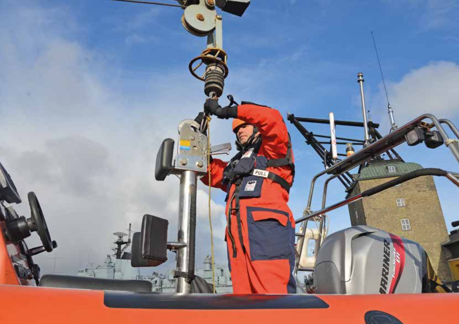
Låsen fastgøres til slippeapparatet på gummibåden. Kranen skal være lodret over slippeapparatet for at undgå et skævt løft, når gummibåden hæves.
